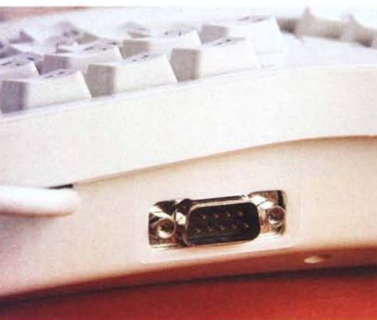
A sinistra: la tastiera dispone di un connettore per il collegamento di un mouse esterno; la commutazione fra mouse e trackpad integrata avviene mediante un interruttore posto sul fondo. A destra: particolare del trackpad e dell'estremità del cordone di collegamento della tastiera al computer.
